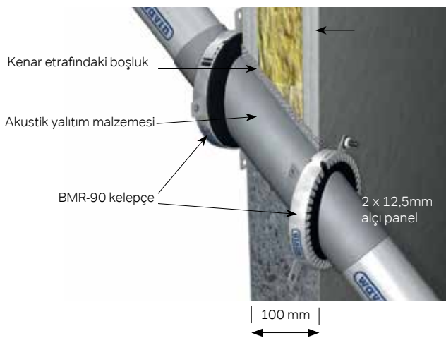
Şekil 25: Manşon/muf ile / manşon/muf olmadan 45° açılı montaj.
