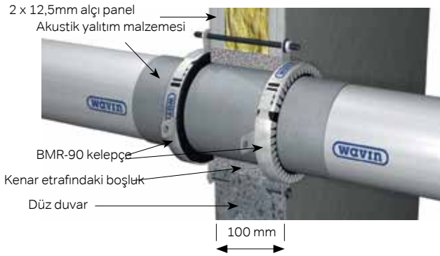
Şekil 24: Manşon/muf olmadan düz montaj.
